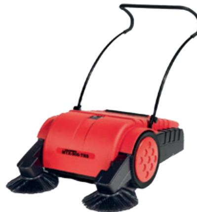
Leichtgängige Handkehrsaugmaschine mit Tandem-Walzen-System und 2 Seitenbesen für die professionelle Anwendung inklusive elektrischen Bürstenantrieb und Staubabsaugung mit 12 V / 35 Ah Batterie und onboard Ladegerät · Auch auf Teppichböden einsetzbar! Arbeitsbreite: ohne Seitenbesen 500 mm, mit 2 Seitenbesen 900 mm · Farbe: Rot RAL 2002
