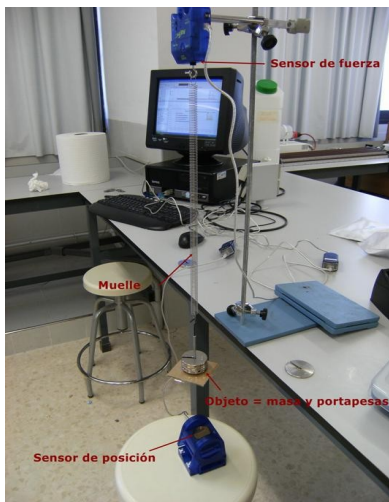
Figura 10.- Dispositivo para estudiar la influencia de la amplitud sobre el periodo de un cuerpo que vibra verticalmente.
