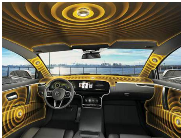
Continental's „Ac2ated“ nutzt die Pkw-Innenverkleidung als Membranfläche – Chassis sind nicht mehr erforderlich.
