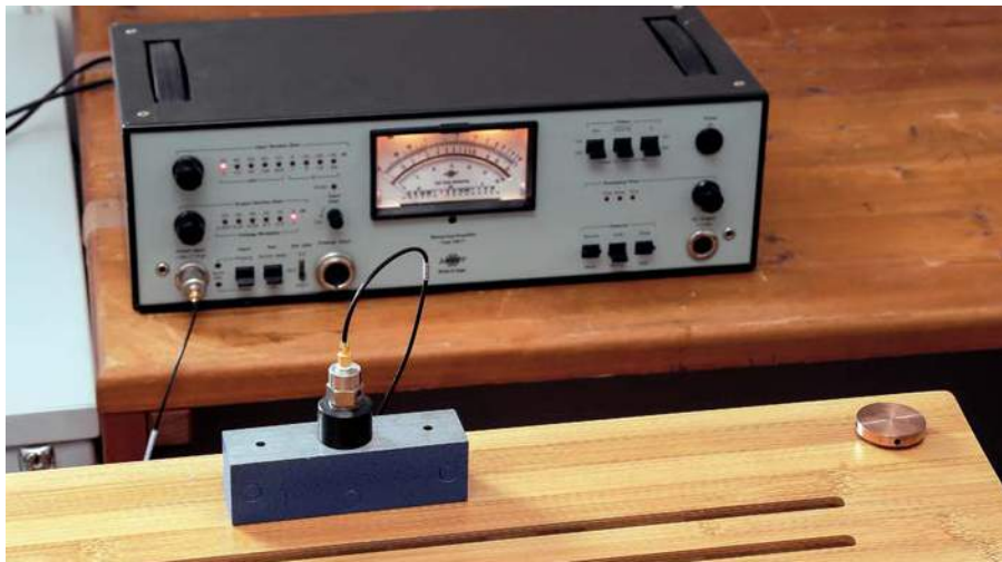
▲ Die breitbandig angeregten Racks wurden alle mit einem Brüel & Kjær-Beschleunigungsaufnehmer und definiertem Sweep auf der Top-Ebene gemessen, einmal pur und mit drei (!) Plattenspielern.
