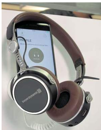
Beyerdynamic kooperiert mit MiMi und verpasst dem neuen Avenho eine DSP-gestützte Frequenzanpassung, die Gehörschäden ausgleichen kann.
