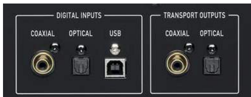
▲ Die digitale Ausgangssection ist praxistgerecht bestückt. Für Computer gibt's eine USB-Schnittstelle.
