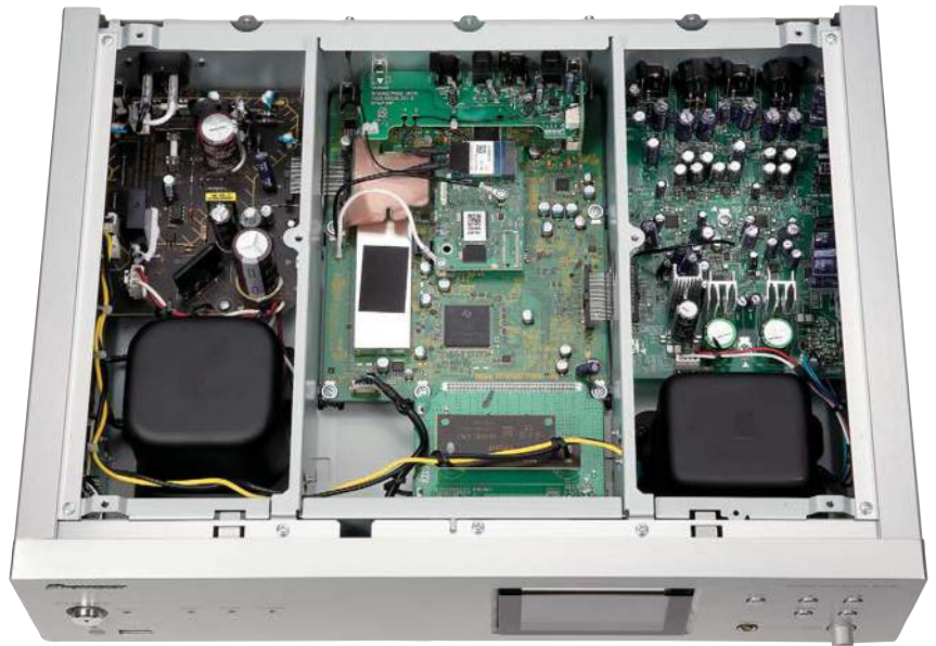
Die Analog- und Digitalabteilungen sind im robusten Gehäuse voneinander isoliert. Man beachte die getrennten Spannungsversorgungen der drei Sektionen.
