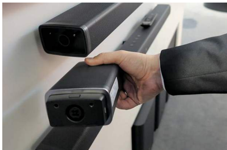
JBLs Bar 5.1 besitzt abnehmbare Endstücke, die sich als Surround-Monitore betreiben lassen und zum Laden an die Soundbar angeklippt werden – auch dabei spielen sie mit und verbreitern die Stereobühne.
