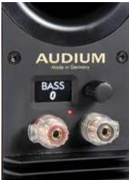
◀ Bassreflexöffnung, Single-Wiring-Terminal und digitales Klangtuning – die Audium hat ein sehr eigenständiges Konzept.
