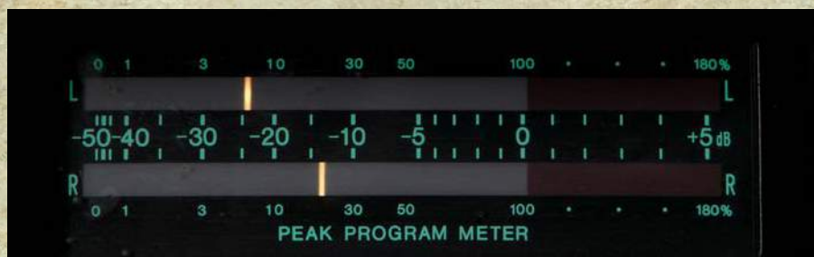
▲ Das „Peak Program Meter“ lässt sich auf verschiedene Betriebsmodi umschalten und reagiert verzögerungsfrei auf Impulse.
