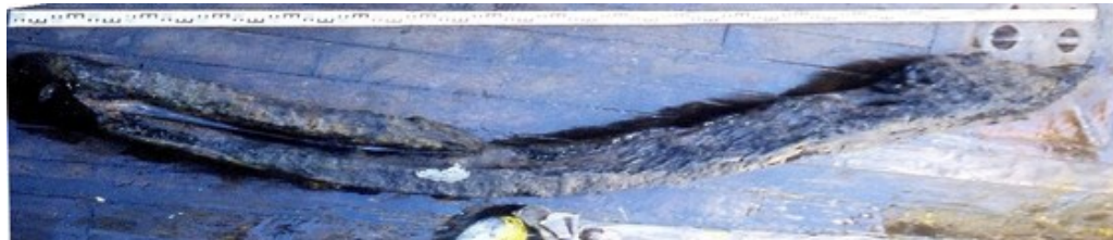
Abbildung 71: Poel 11 . Entzerrte Fotografie des „Lot“ genannten Übergangsstückes zwischen Kiel und Vordersteven.
