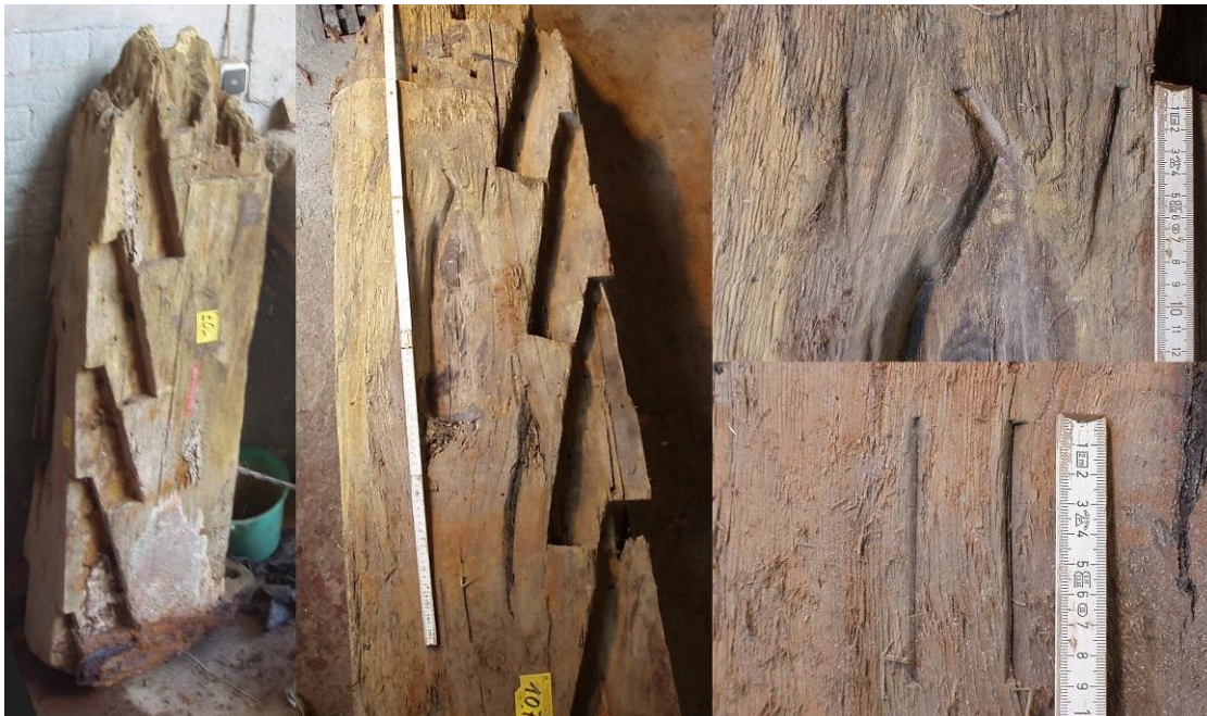
Abbildung 68: Poel 11. Achterstevens mit treppenförmiger Sponung zur Aufnahme der unteren Plankenenden. Das Bauteil zeigt neben deutlichen Wuchsfehlern auch eine Zwei- und eine Vierfuß-Tiefgangsmarkierung.
