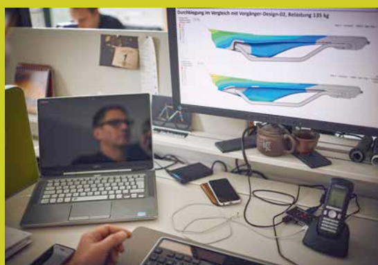
FEM-Verformungsberechnung des ergonomischen Kerns
