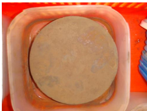
Figura 2. Placa de Hierro de 17 cm de diámetro, 0.6 cm de espesor y 226 cm 2 de área, antes de ser sumergida en la zona costera de Campeche. Fotografía: Cortesía INAH/SAS Fotógrafo: Elda Itzel Carrasco.
