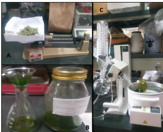
Figura 18. Obtención de extracto orgánico para CCD. A. Pesaje del material vegetal seco. B. Macerado de L. mexicana . C. Concentración a presión reducida
