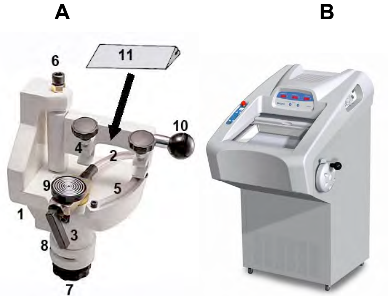
Figura 4: A) Micrótomo de congelación Tipo Leitz 1213. (1) Mecanismo de sujeción a la mesa de trabajo. (2) tubo de conexión la botella de CO 2 . (3) Llave de paso para el gas. (4) Porta cuchillas con dos tornillos de sujeción de la cuchilla. (5) Rail de deslizamiento de la cuchilla. (6) Eje de giro de la cuchilla. (7 y 8) Tornillo de avance (7) y palanca (8) para subir y bajar la platina (9) en la que se deposita y congela la muestra. (10) Manubrio para deslizar la cuchilla sobre la pieza congelada. (11) Cuchilla. B) Modelo de criostato.
