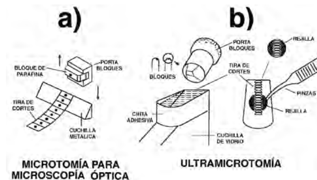
Figura 13: (a) Obtención de cortes seriados de bloques de parafina. (b) Obtención de cortes seriados de bloques de resinas o plásticos. Obsérvese que las tiras de cortes flotan en la superficie del agua de la piscina y que son "pescados" con una rejilla metálica de 3 mm de diámetro.
