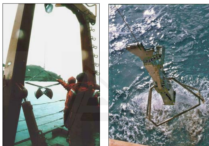
Figura 2.8. Muestreadores utilizados en la captura de infauna, pero que también han recolectado tunicados bentónicos (de izda. a dcha.): cuchara Van Veen 0,1m 2 ; box-corer 0,1m 2 (imágenes cedidas por A.A. Ramos-Esplá)
