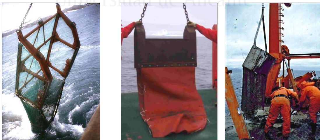
Figura 2.7. Tipo de dragas utilizadas en la recolección de tunicados bentónicos (de izda. a dcha.): draga Agassiz; draga de roca; y draga de ancla (imágenes cedidas por A.A. Ramos-Esplá).
