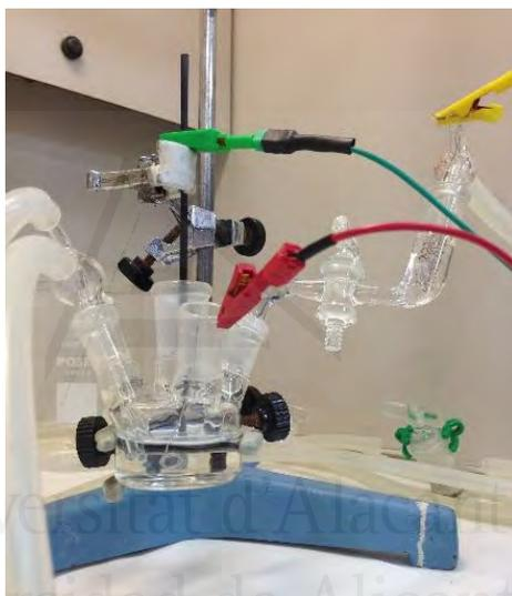
**Figura 2.3.** Celda electroquímica de tres electrodos.
