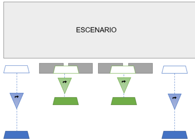
Figure 6- Posición ficticia mediante el uso de delay para los diferentes sistemas.
