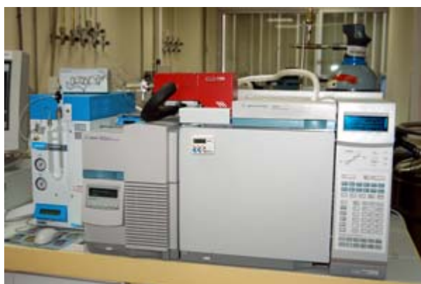
Figura 3. Sistema acoplado Desorción Térmica o Purga Trampa – Cromatógrafo de Gases – Espectrómetro de Masas.
