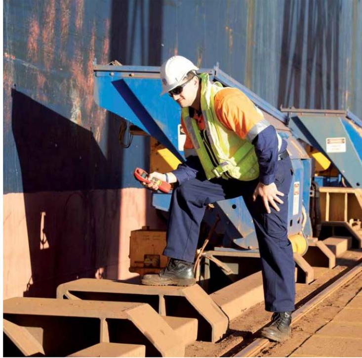
**Ilustración 14: Cavotec MoorMaster: Unidades controladas por control remoto en el Puerto de Hedland, Australia. (Fuente: [www.cavotec.es](http://www.cavotec.es))**
