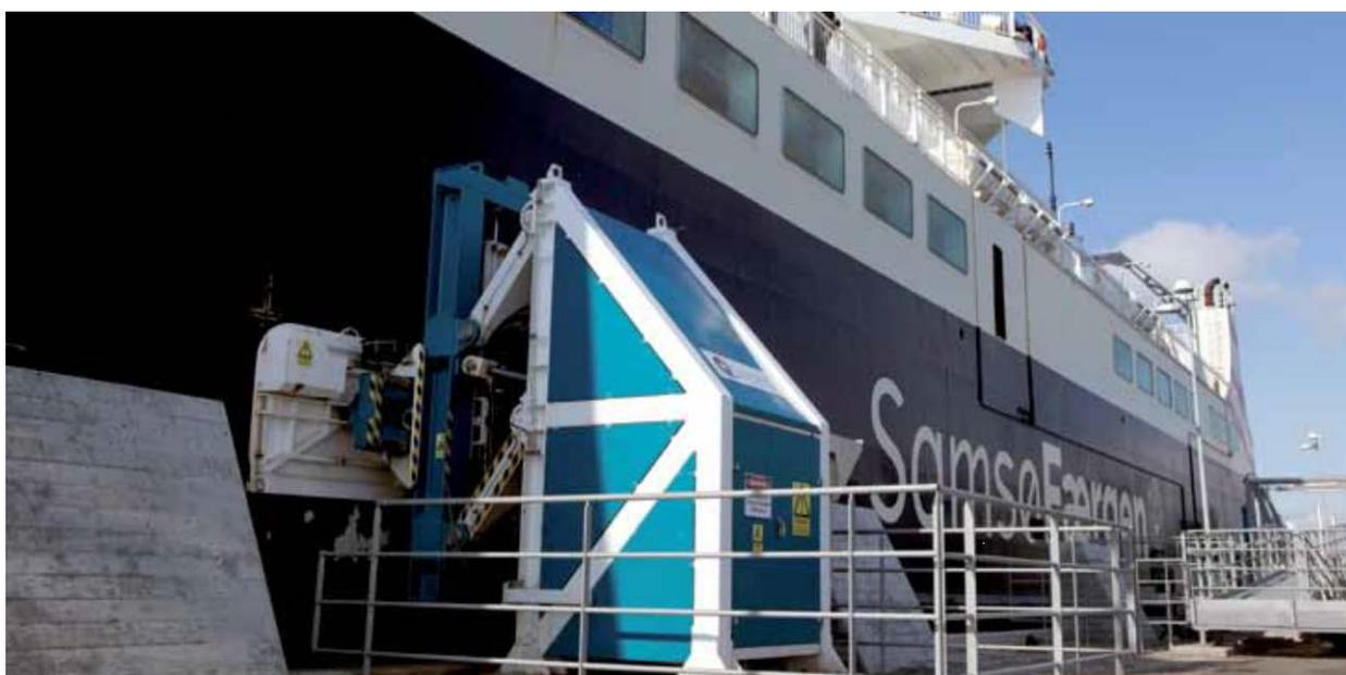
Ilustración 13: *MoorMaster: Unidades de amarre automatizadas en el Puerto de Saelvig, Dinamarca.* (Fuente: [www.cavotec.es](http://www.cavotec.es))
