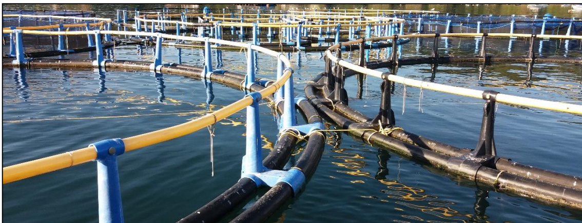
Fig. 4. Detalle de una jaula donde se muestran los dos anillos, los pedestales y la barandilla.
