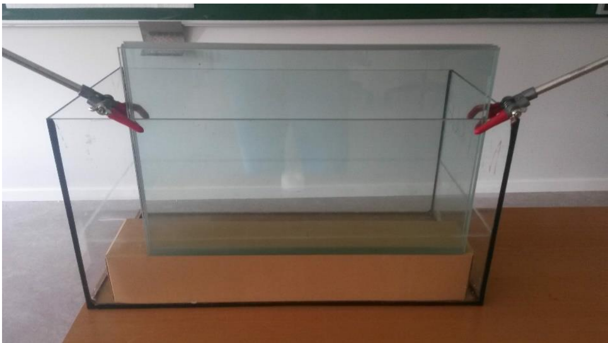
Figur 4: fastholdelse af de 5 glasplader med laboratorieklemmer
