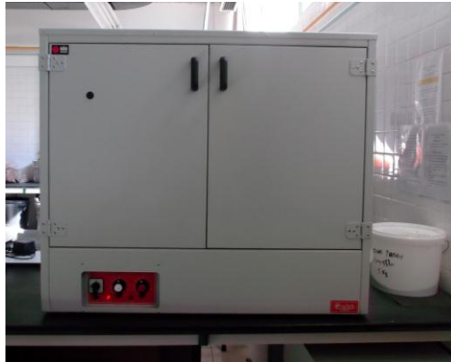
Figura 4.1 - Estufa ventilada utilizada para o aquecimento dos betumes.
