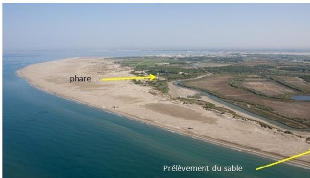
Fig. 5 : Pointe de l'Espiguette. On remarque que la partie orientale du site (prélèvement du sable) attaquée par la mer régresse inexorablement et que la pointe située à l'ouest (position du phare) engraisse de manière conséquente (plusieurs mètres par an).
