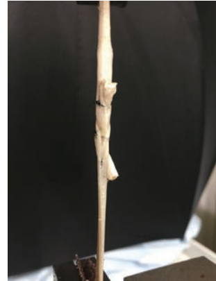
図3 牽引負荷試験 サンドペーパーを介して腱の両端を把持し、5から15Nの力で0.25Hzで1000サイクル牽引を繰り返す。
