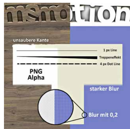
Abbildung 2: Testtextur mit unterschiedlichen Situationen, um die PVR-Texturkompression herauszufordern.
