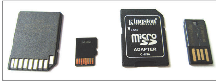
Abbildung 1.8 Eine SD-Karte in Standardgröße, eine Micro-SD-Karte, ein SD-Karten-Adapter sowie ein winziger USB-Adapter für Micro-SD-Karten
