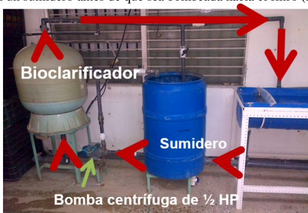
Figura 1. Sistema de recirculación de agua para el levantamiento de larvas de cachamas. El sistema se diseñó con bioclarificador (filtro mecánico y biológico), un sumidero y 4 tanques de 200 L de capacidad.
