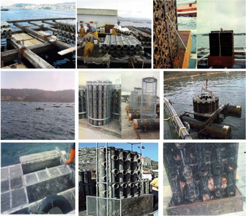
Figura 3.- Sistemas industriales de engorde. En la fila superior se muestran sistemas de plataforma (batea), con diferentes tipos de refugios. Las filas intermedia e inferior muestran sistemas autoflotantes con jaulas de sección circular y cuadrada, con los respectivos tipos de refugios.
