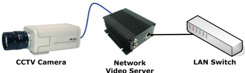
Abbildung zeigt CCTV-Kamera, die über einen Netzwerk-Videoserver mit dem Netzwerk verbunden ist.
