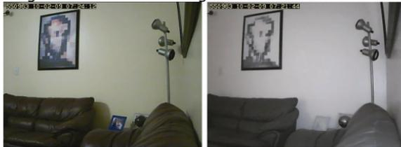
Links: IR = Aus. Rechts: IR = Ein oder Automatisch
