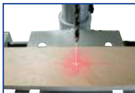
Laser pointing device for high precision drilling Dispositivo de puntero láser para la perforación de alta precisión
