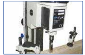
Supporting and sealing guide of the work pieces Guía de apoyo y sujeción de las piezas de trabajo
