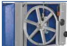
354mm flywheels and blade tensioning device Volantes de diámetro 354 mm y indicador de tensión de la cinta
