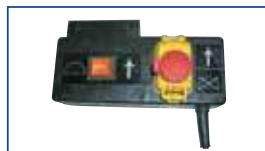
Function selector for choosing to use the saw or the miller Selector de funciones para elección de utilizar la sierra o la fresadora
