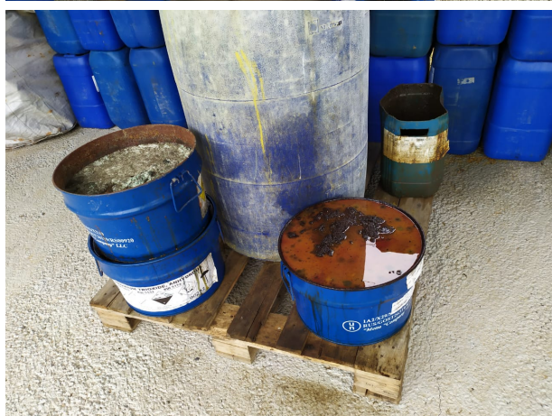
Figura 17 – Local de armazenamento de resíduos perigosos construído recentemente sem comunicação ao órgão ambiental e sem dispositivo de contenção de vazamentos líquidos.
