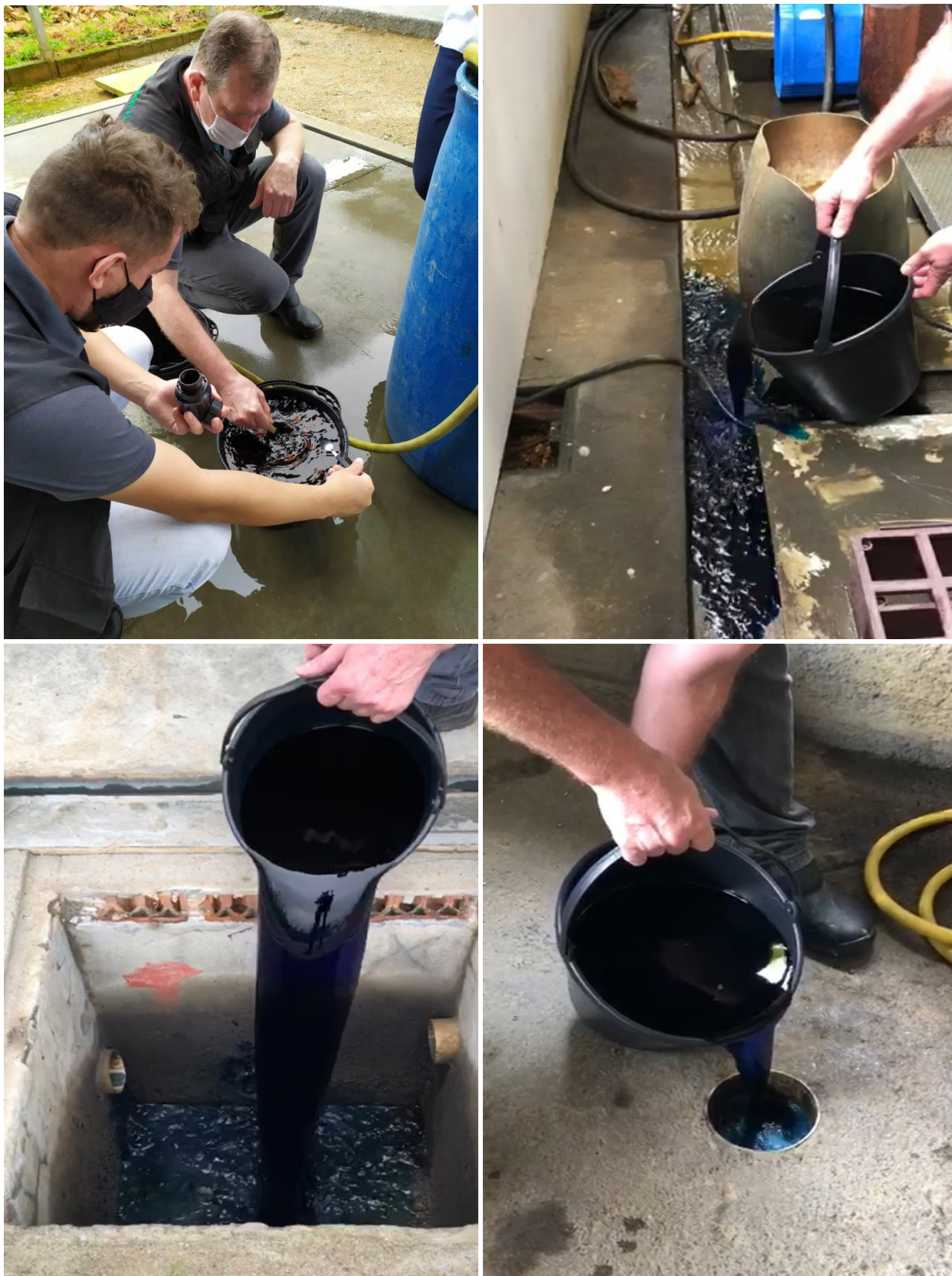
Figura 07 – Utilização de corante/solução para verificação do fluxo do efluente.
