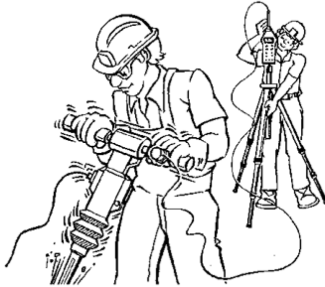
Figura 5.1 - Disposición del equipo medidor de vibraciones
