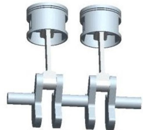
Dieser 2-Zylindermotor hat jetzt zwar keine freien Massen**momente** mehr, dafür aber wieder sehr starke freie Massen**kräfte** (nämlich genau doppelt so starke wie der 1-Zylindermotor). Mit dem Reihen-4-Zylinder 4-Takt kommt man aus dieser Zwickmühle heraus:
