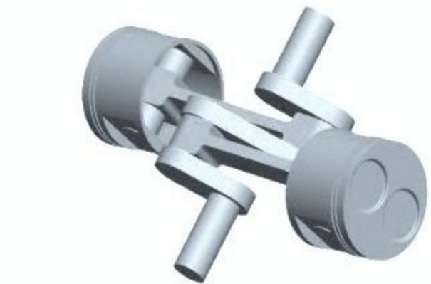
Wenn man einmal vernachlässigt, dass die gegenüberliegenden Kolben leicht versetzt sind, dann hat der Boxermotor keinerlei freie Kräfte und Momente, unabhängig von der Zylinderzahl (diese muss natürlich gerade sein). Also durchaus eine feine Sache!
