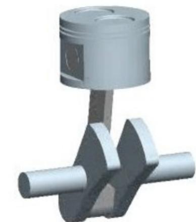
Die Bewegung der Pleuelstange ist durchaus komplex. Der Einfachheit halber teilt man die Pleuelstange daher in zwei fiktive Massen auf. Ein Teil wird zur „rotierenden Masse“ geschlagen, der andere Teil zur „oszillierenden Masse“. (Die oszillierende Masse ist die Masse die sich auf- und ab bewegt. Also der Kolben.)
