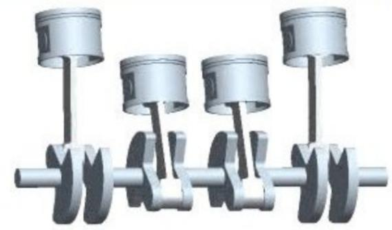
Der 4-Zylinder weißt weder freie Massenkräfte erster Ordnung noch freie Massenmomente erster Ordnung auf! Das ist der eigentliche Grund, warum 4-Zylinder Motoren so weit verbreitet sind!
