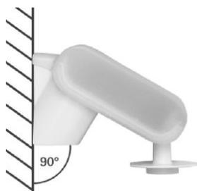
Die Wetterstation muss an einer senkrechten Wand (bzw. einem Mast) angebracht werden.
