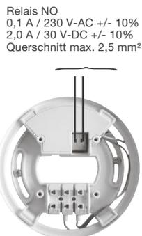
3. Den Anschluss-Sockel mit dem Montage-Sockel des Melders verdrahten, dabei geeignete Kabel verwenden (Typ H07V-K x 1,5 mm<sup>2</sup>; 2,6 mm auf Seiten des Melders und 12 mm auf Seiten des Anschluss-Sockels abisolieren).
