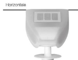
Die Wetterstation muss in der Querrichtung horizontal (waagrecht) montiert sein. Unter der Wetterstation muss mind. 60 cm Freiraum gelassen werden, um eine korrekte Windmessung zu ermöglichen
