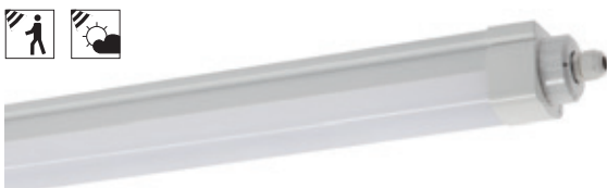
PFYB ... DV3-RS Innenliegende Durchgangsverdrahtung, 3 x 1,5mm 2 . Radarsensor für Bewegungserkennung eingebaut. Montagehöhe bei Deckenmontage max. 6m, bei Wandmontage max. 3m. Erfassungsbereich bei Deckenmontage max. 14m, bei Wandmontage max. 10m. Leuchtenlichtstrom einstellbar über DipSwitch (Werkseinstellung: Maximaler Lichtstrom).
