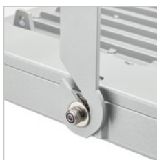
GentleSpace mit Montagebugel (BR): Zur einfachen Montage wird der verstellbare Montagebugel vorab an der Decke befestigt und die Leuchte anschlieend eingehangt.
