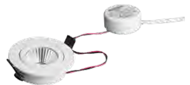
LED-Konverter 350 mA, mit Phasenanschnitt/-abschnitt, für 68 mm Deckeneinbauöffnungen
