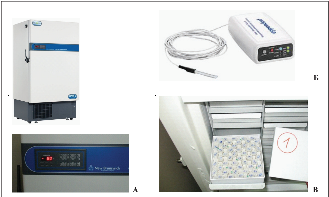
Рисунок 6. ДНК-банк редких и экономически важных таксонов коллекций ЦБС: А – общий вид ультраморозильника New Brunswick™ Innova® 750, Б – система мониторинга устойчивого хранения образцов при низких температурах; В – система устойчивого хранения образцов при низких температурах
