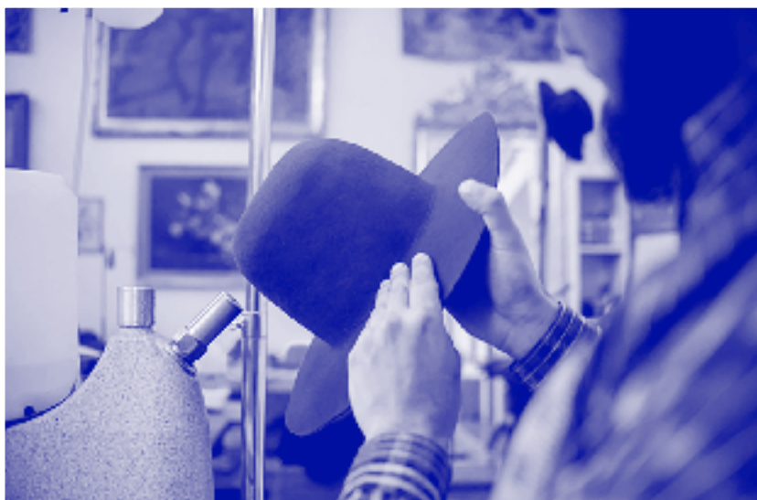
Aplicación de vapor para suavizar el material y poder trabajar la forma de la copa a mano. Fotografía: Merab Carrera, 2020.
