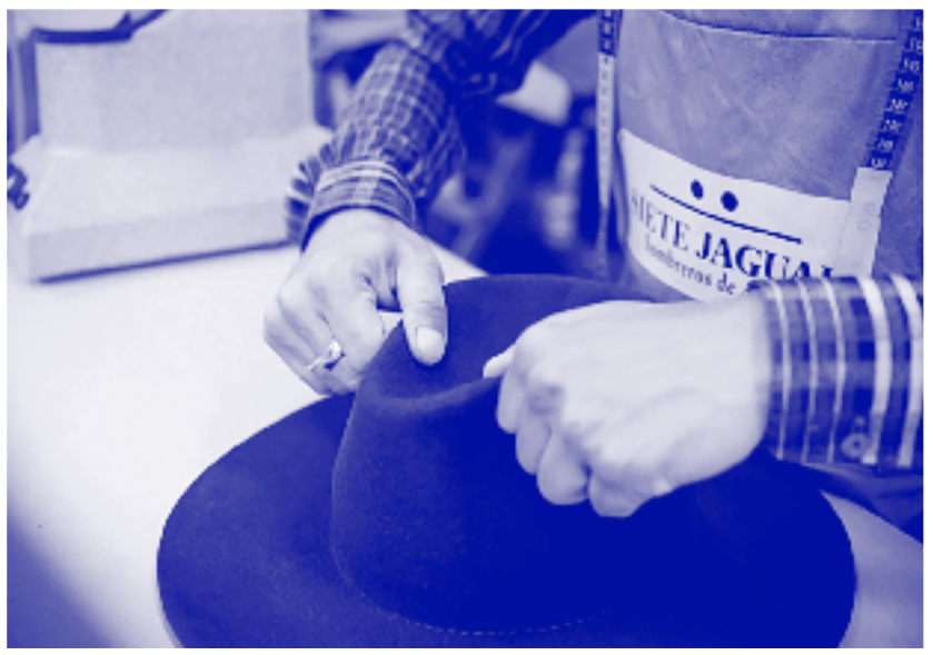
Planchado a mano, a base de vapor. Fotografía: Merab Carrera, 2020.
