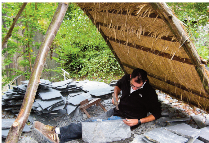
Clivage des ardoises (photo André Schneider – Adasta)
