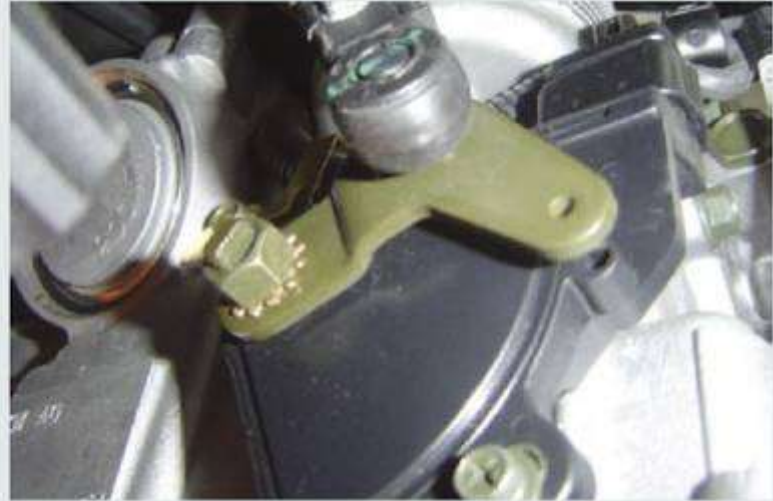
↑ Figura 4.75. Captador de la posición de la palanca F 125.
