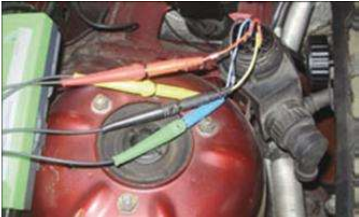
Figura 4.69. Conexión del KTS al conector BMW antiguo.
