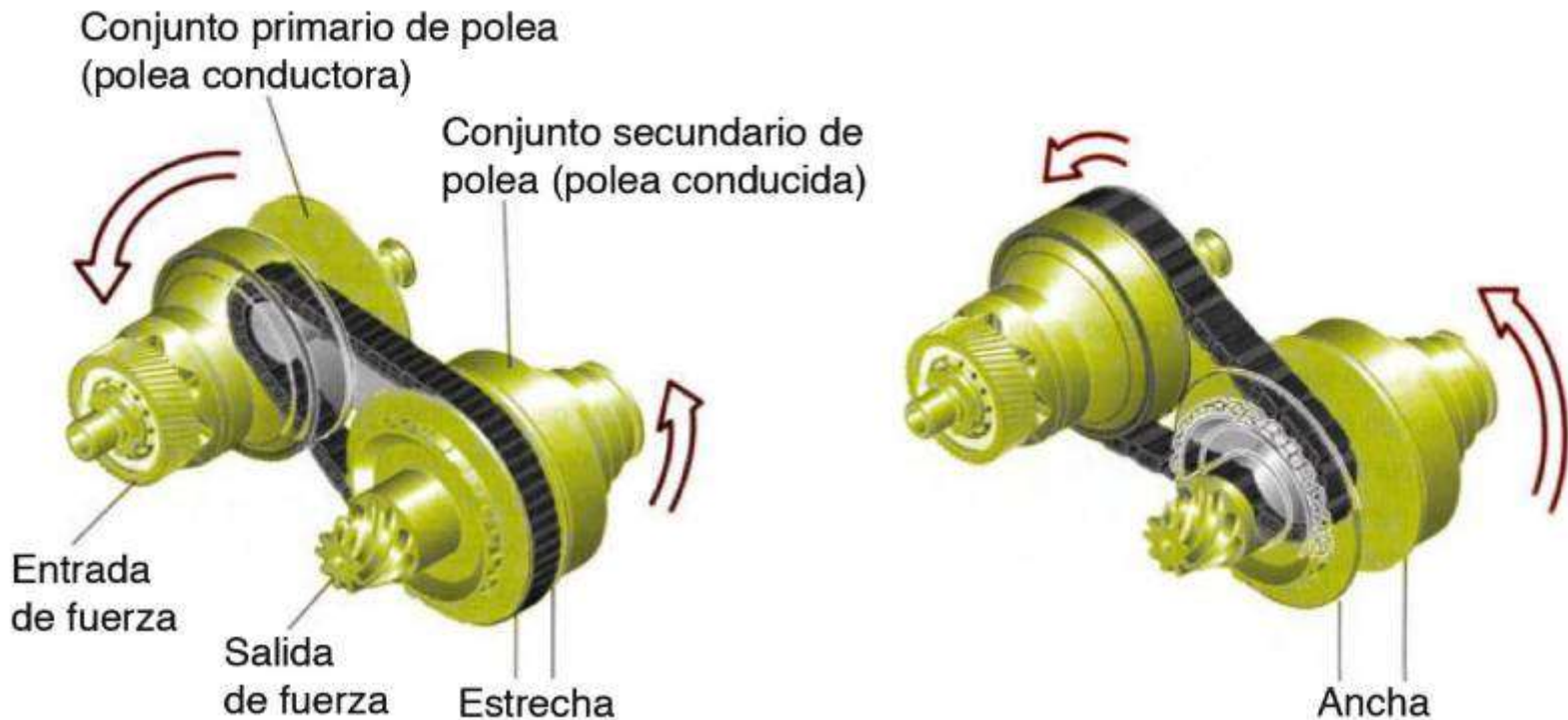
Figura 4.58. Funcionamiento del CVT multitronic.
