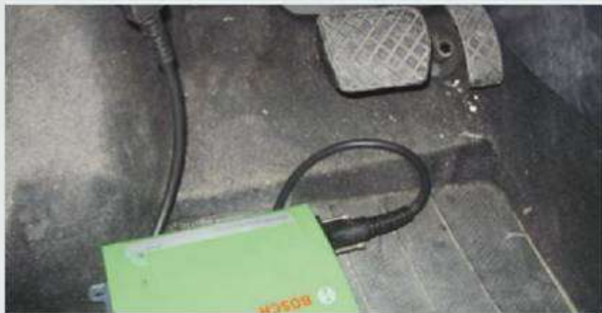
↑ Figura 4.77. Conectar el equipo de diagnosis.
