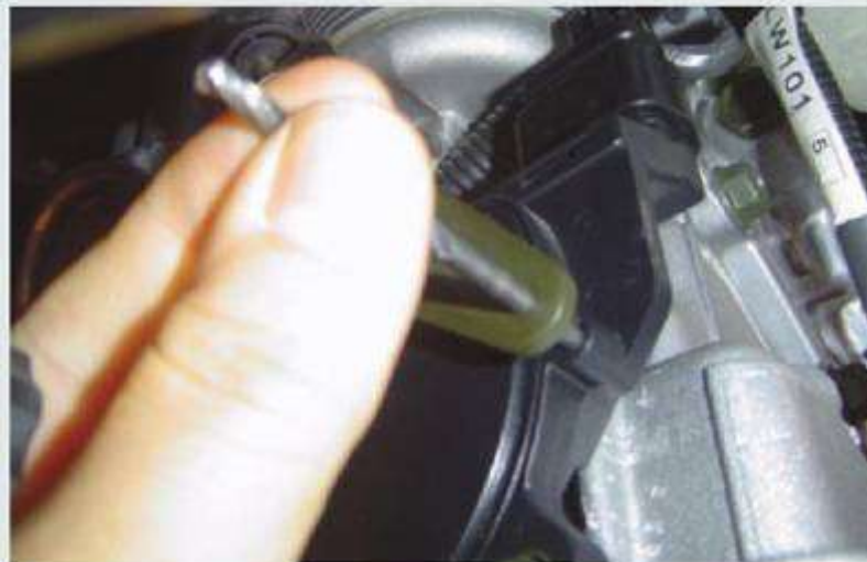
↑ Figura 4.76. Comprobando el ajuste con la broca de 4 mm.
