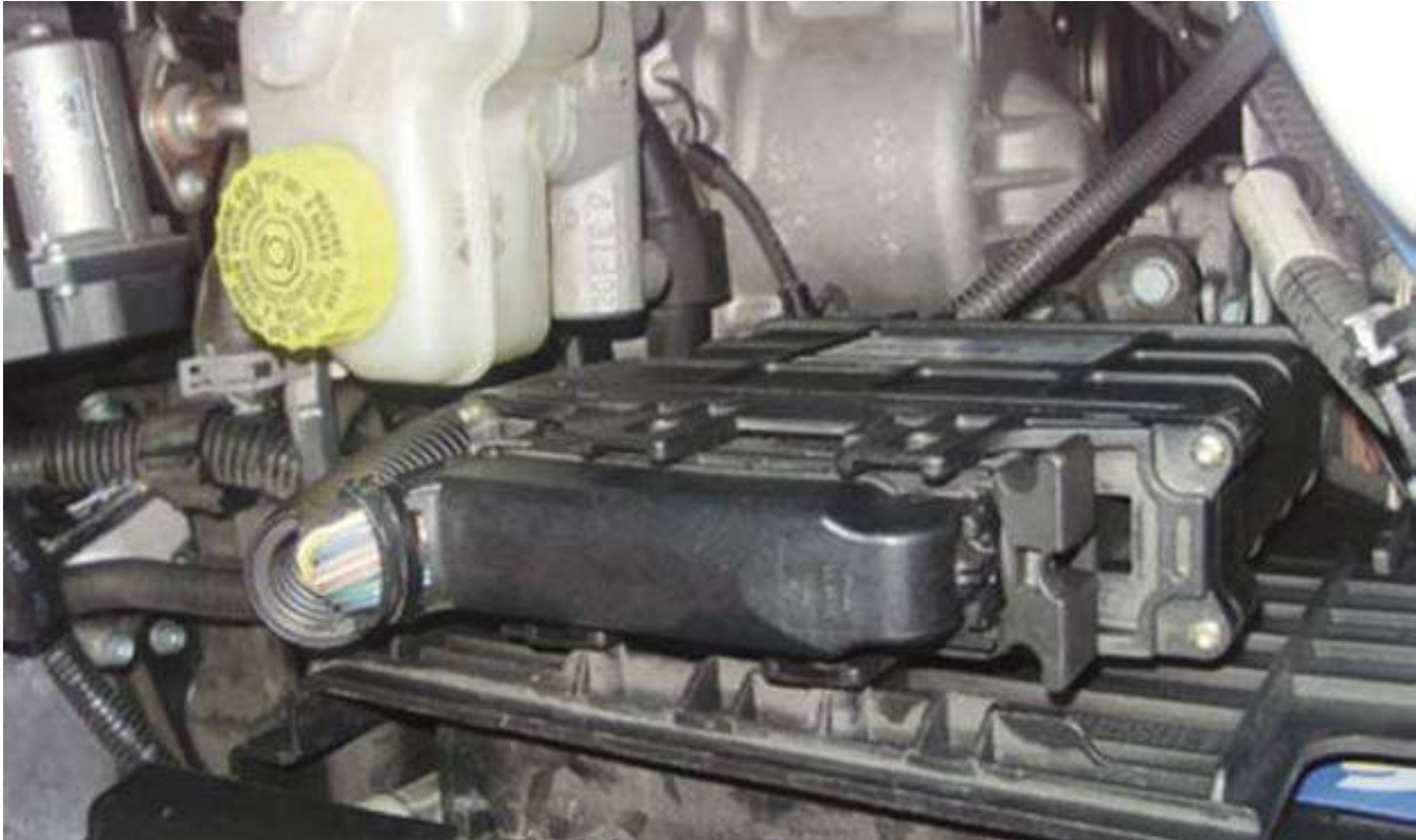
Figura 4.36. Módulo electrónico del cambio independiente.
