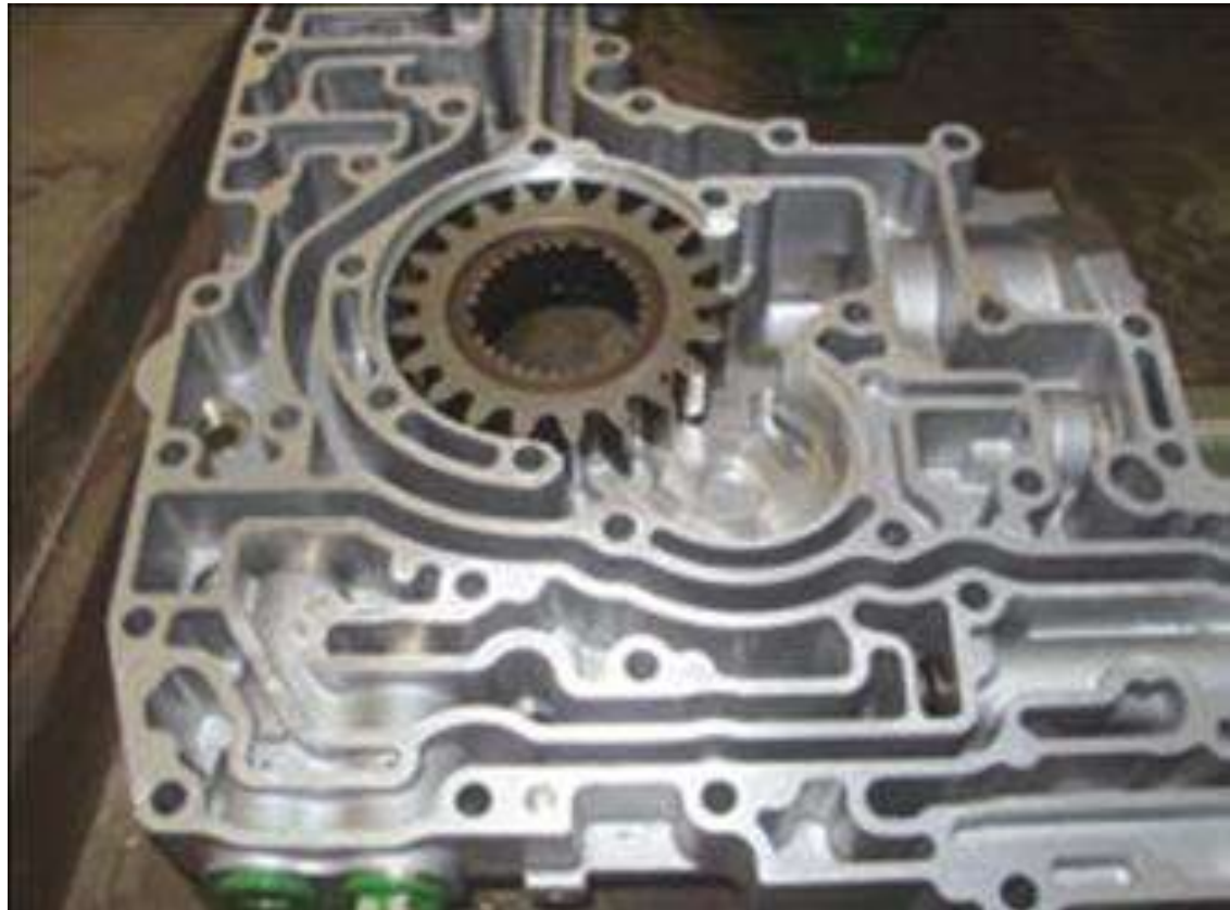
Figura 4.31. Piñón de la bomba y canalizaciones de la caja de válvulas.
