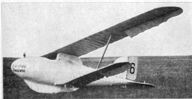
Heidelberg „Kurpfalz Sauzahn“ (1923) E: R. Eck, H. G. Bader, Heidelberg; A: Waggonfabrik Fuchs, Heidelberg. S: 1; St: Schw.; Bst: H; l = 4,90 m; h = 1,65 m; b = 14,00 m; t = 0,80 m; b/t = 1 : 33; F = 15,00 m 2 ; Sfl = 0,60 m 2 ; Sr = 0,63 m 2 ; Gr = 120,00 kg; Gz = 70,00 kg; G = 190,00 kg; G/F = 12,00 kg/m 2 .
