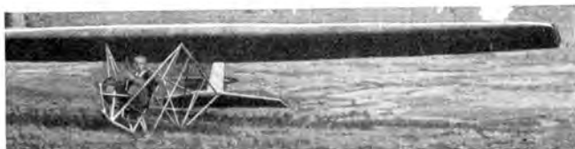
Mähr.-Schoenberg S. E. II (1924) E: H. Kromer, Frankenhausen; A: Deutscher Fliegerbund, Mähr.-Schoenberg. S: 1; St: Schw; Bst: H, St; P: Göttingen 441. — l = 5,75 m; b = 12,00 m; t = 1,50 m; b/t = 1 : 8,0 ; F = 16,00 m 2 ; Sr = 1,00 m 2 ; Gr = 120,00 kg; Gz = 70,00 kg; G = 190,00 kg; G/F = 11,90 kg/m 2 .
