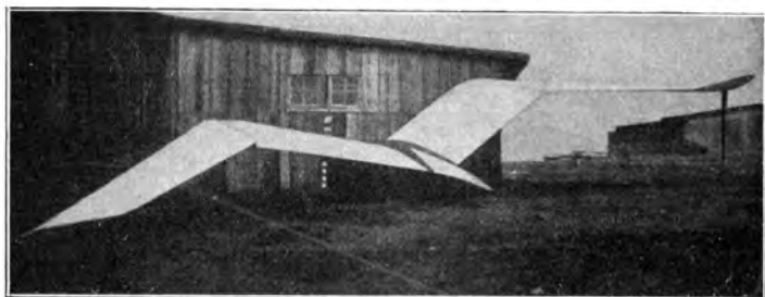
Weltensegler „Baden-Baden-Stolz“ (1922) E: F. Wenk, Tübingen; A: Segelflugzeugwerke G. m. b. H., Baden-Baden. S: 1; St: Fl.; Bst: H. — l = 3,00 m; h = 1,00 m; \bar{b} = 15,00 m; t = 1,25 m; b/t = 1: 12,0; F = 16,20 m 2 ; Gr = 100,00 kg; Gz = 70,00 kg; G = 170,00 kg; G/F = 10,60 kg/m 2 .
