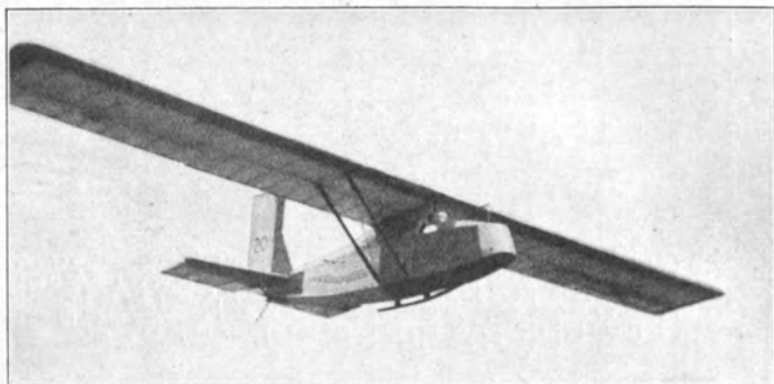
Dresden „Baunummer 7“ (1929) E: Fr. Schicht, Dresden; A: Akad. Fliegergruppe T. H. Dresden. S: 1; St: Schw.; Bst: H. — l = 5,50 m; h = 2,00 m; b = 12,00 m; F = 18,00 m 2 .
