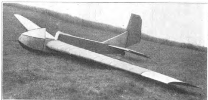
Amstutz „Thun“ (1927) E: Blaser, Lergier, Bern; A: E. Amstutz, H. Belart, H. v. Travel, Bern. S: 1; St: Schw.; Bst: H. — l = 5,00 m; b = 17,00 m; F = 17,50 m 2 ; Gr = 65,00 kg; Gz = 75,00 kg; G = 140,00 kg; G/F = 8,00 kg/m 2 .
