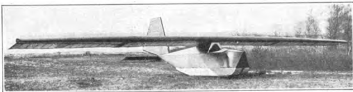
Danzig „Boot-Danzig“ (1926) E: H. Wiederhold, Danzig; A: Akademische Fliegergruppe T. H. Danzig. S: 1; St: Schw.; Bst: H. — l = 7,00 m; b = 13,00 m; t = 1,16 m; b/t = 1:11,9 ; F = 14,20 m 2 ; H_r = 1,80 m 2 ; S_r = 0,72 m 2 ; G_r = 138,00 kg; G_z = 70,00 kg; G = 208,00 kg; G/F = 14,40 kg/m 2 .
