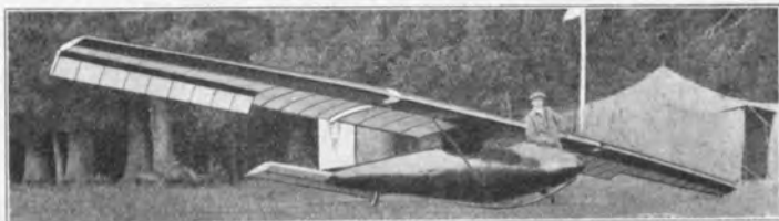
Graz „Sturmvogel“ (1927) E: Spieß, Floedel, Graz; A: Akad. Fliegergruppe T. H. Graz. S: 1; St: Schw.; Bst: H; P: Göttingen 482. — l = 5,50 m; b = 15,00 m; t = 1,10 m; b/t = 1:13,6 ; F = 17,00 m 2 ; Gr = 110,00 kg; Gz = 70,00 kg; G = 180,00 kg; G/F = 10,60 kg/m 2 .
