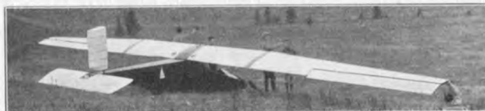
Graz „Vandale“ (1926) E: K. u. F. Pernthaler, Graz; A: Akad. Fliegergruppe T. H. Graz. S: 1; St: Schw.; Bst: H; P: Göttingen 441. — B.-L.: St: 15,5 km. — l = 5,60 m; b = 15,50 m; t = 1,10 m; b/t = 1:14,0 ; F = 17,00 m 2 ; Gr = 120,00 kg; Gz = 70,00 kg; G = 190,00 kg; G/F = 11,20 kg/m 2 .
