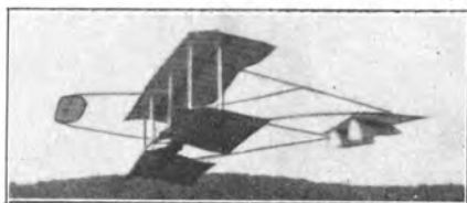
Darmstadt F. S. V. 2c (1910) E. H. Gutermuth, Darmstadt; A: Darmstädter Flugsportvereinigung, Darmstadt. S: 1; St: Schw.; Bst: H; l = 5,20 m; b = 7,00 m; t = 2,00 m; b/t = 1:3,5 ; F = 30,00 m 2 ; Gr = 25,00 kg; G_z = 60,00 kg; G = 85,00 kg; G/F = 2,8 kg/m 2 .
