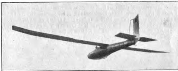
Darmstadt „Konsul“ (1923) E: A. Botsch, R. Spieß, Darmstadt; A: Bahnbedarf A.-G., Darmstadt, Akad. Fliegergruppe T. H. Darmstadt. S: 1; St: Schw.; Bst: H; P: Göttingen 535; vg = 14,80 m/s; Gwkl = 1: 21,4. — B.-L.: St: 24,4 km. — l = 6,20 m, h = 1,30 m; b = 18,20 m; t = 1,20 m; b/t = 1: 15,8; F = 21,00 m 2 ; Hfl = 2,00 m 2 ; Hr = 3,20 m 2 ; Sfl = 0,78 m 2 ; Sr = 1,50 m 2 ; Gr = 180,00 kg; Gz = 80,00 kg; G = 280,00 kg; G/F = 13,30 kg/m 2 .
