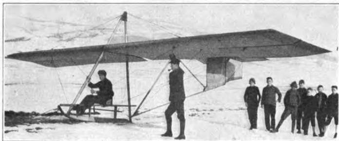
Espenlaub S (1924) E: G. Espenlaub, Grunau; A: G. Espenlaub, Grunau. S: 1; St: Schw.; Bst: H. - l = 6,10 m; h = 2,80 m; b = 12,00 m; F = 22,00 m 2 ; Gr = 150,00 kg; Gz = 70,00 kg; G = 220,00 kg; G/F = 10,00 kg/m 2 .
