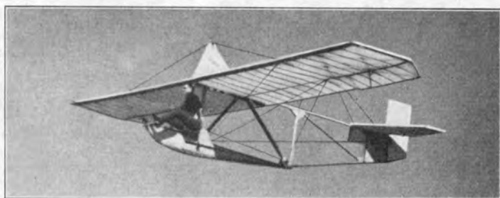
R. R. G. „Zögling“ (1926) E: A. Lippisch, Wasserkuppe F. Stamer; A: Rhön-Rossitten-Gesellschaft, Wasserkuppe. S: 1; St: Schw.; Bst: H; P: Göttingen 358; Vg = 12,50 m/s; Gwkl = 1:11. — l = 5,48 m; h = 2,20 m; b = 10,00 m; t = 1,60 m; b/t = 1:6,2; F = 15,85 m 2 ; Gr = 85,00 kg; Gz = 70,00 kg; G = 155,00 kg; G/F = 9,80 kg/m 2 .
