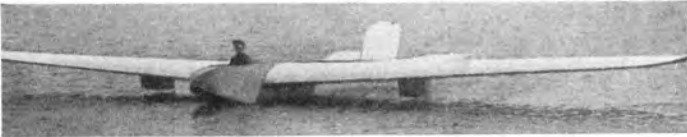
L. F. G. „Boot-Phönix“ (1922) E: G. Baatz, Stralsund; A: Luftfahrzeug-Ges., Stralsund. S: 1; St: Schw.; Bst: H. — l = 7,10 \text{ m} ; h = 0,90 \text{ m} ; b = 16,00 \text{ m} ; t = 1,90 \text{ m} ; b/t = 1:8,4 .
