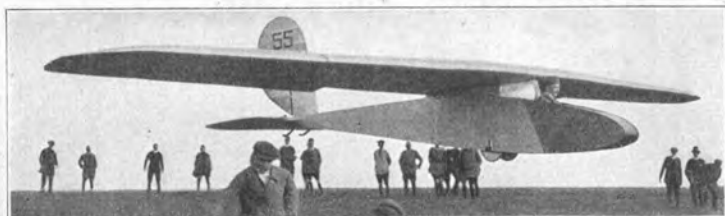
A. W. F. „Moskau“ (1926) A: Aviaturst, Moskau. S: 1; St: Schw.; Bst: H. — l = 6,40 \text{ m} ; b = 14,00 \text{ m} ; t = 1,65 \text{ m} ; b/t = 1:10,9 ; F = 18,00 \text{ m}^2 ; Hr = 2,00 \text{ m}^2 ; Sfl = 0,20 \text{ m}^2 ; Sr = 1,40 \text{ m}^2 ; Gr = 110,00 \text{ kg} ; Gz = 70,00 \text{ kg} ; G = 180,00 \text{ kg} ; G/F = 10,00 \text{ kg/m}^2 .
