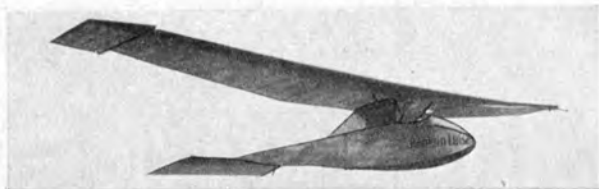
Schulz „Königin Luise“ (1924) E: F. Schulz, Waldensee; A: Möbelfabrik Marienburg. S: 1; St: Schw.; Bst: H. — l = 5,00 m; h = 1,40 m; b = 14,00 m; t = 1,10 m; b/t = 1:12,7 ; F = 15,50 m 2 ; Gr = 104,50 kg; Gz = 70,00 kg; G = 174,50 kg; G/F = 12,00 kg/m 2 .
