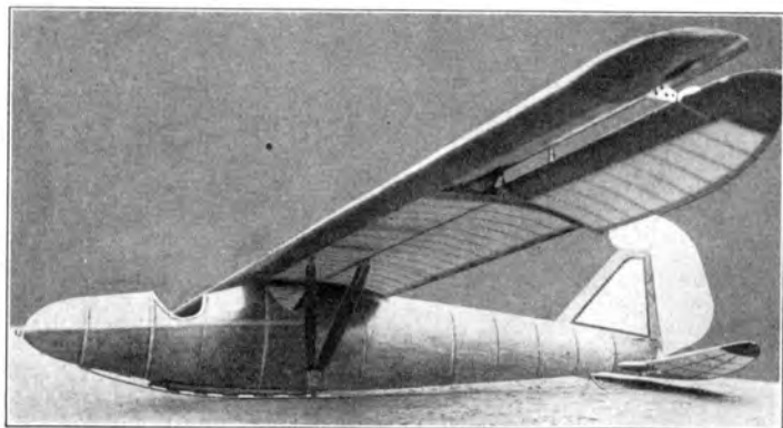
Görnitz „Görnitz 1“ (1926) E: W. Hübner, Adlershof; A: D. L. V.-Gruppe, Görnitz. S: 2; St: Schw.; Bst: H. — b = 15,00 m; F = 21,00 m 2 ; Gr = 175,00 kg; Gz = 140,00 kg; G = 315,00 kg; G/F = 12,30 kg/m 2 .
