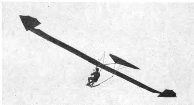
Schulz F. S. 3 (1922) E: F. Schulz, Waldensee; A: F. Schulz, Waldensee. S: 1; St: Schw., Fl.; Bst: H. — B.-L.: D: 8:42:0 h. — l = 4,50 m; b = 12,50 m; t = 1,60 m; b/t = 1:7,8; F = 16,00 m 2 ; Hfl = 1,10 m 2 ; Hr = 0,90 m 2 ; Qr = 2,40 m 2 ; Tg = 31,00 kg; Lg = 16,30 kg; Gr = 47,30 kg; Gz = 75,70 kg; G = 123,00 kg; G/F = 7,60 kg/m 2 .
