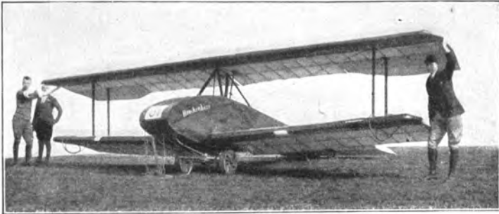
Braunschweig S B 2 „Brockenhexe“ (1923) E: F. Haarmann, Braunschweig; A: Flugwiss. Gruppe T. H. Braunschweig. S: 1; St: Schw.; Bst: H. — l = 5,70 m; h = 1,95 m; b = 8,40 m; F = 18,00 m 2 .
