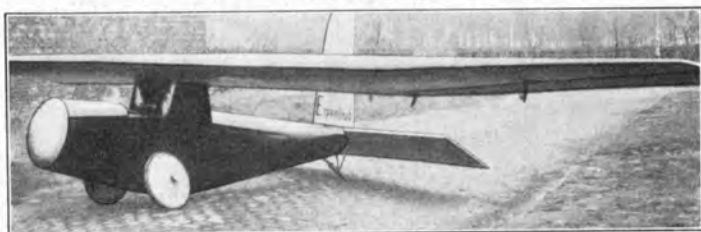
Espenlaub „Schleppflugzeug“ (1927) E: G. Espenlaub, Düsseldorf; A: G. Espenlaub-Flugzeugbau, Düsseldorf. S: 1; St: Schw.; Bst: H. — l = 6,00 m; b = 10,00 m.
