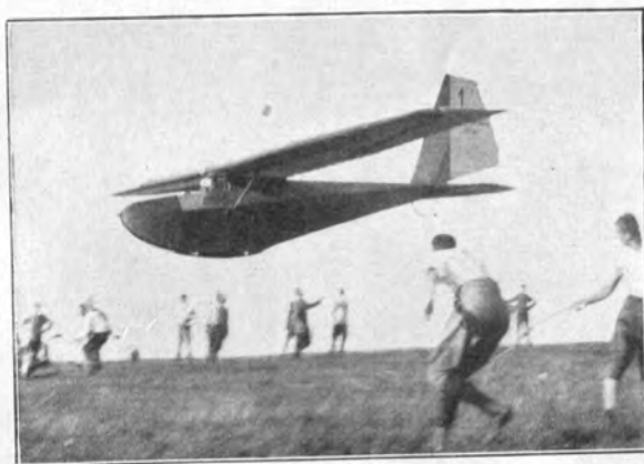
Dessau „Der Dessauer“ (1923) E: L. Hoffmann, Dessau; A: Flugtechnischer Verein, Dessau. S: 1; St: Schw.; Bst: H; P: Göttingen 289. — l = 5,70 m; h = 1,35 m; b = 12,80 m; t = 1,28 m; b/t = 1 : 10,6 ; F = 15,50 m 2 ; Hfl = 0,95 m 2 ; Hr = 1,50 m 2 ; Sfl = 0,44 m 2 ; Sr = 1,30 m 2 ; Qr = 2,32 m 2 ; Gr = 115,00 kg; Gz = 70,00 kg; G = 185,00 kg; G/F = 11,30 kg/m 2 .
