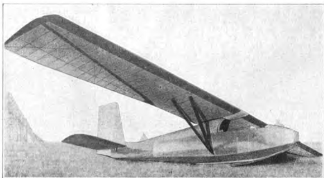
Darmstadt „Margarethe“ (1923) E: F. Hoppe, Darmstadt; A: Akad. Fliegergruppe T.H. Darmstadt. S: 2; St: Schw.; Bst: H; P: Göttingen 533. — B.-L.: D: 5:40:0 h; — l = 7,75 m; h = 1,70 m; b = 15,30 m; t = 1,65 m; b/t = 1 : 9,0 ; F = 22,50 m 2 ; Hfl = 2,10 m 2 ; Hr = 3,00 m 2 ; Sfl = 0,72 m 2 ; Sr = 0,80 m 2 ; Gr = 200,00 kg; Gz = 150,00 kg; G = 350,00 kg; G/F = 12,40 kg/m 2 .
