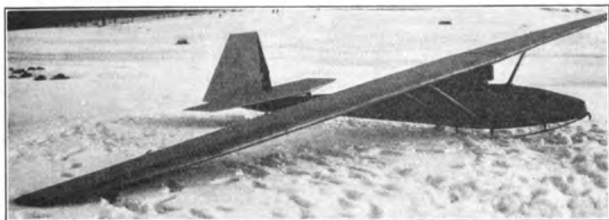
Konrad Ko Ro 4 (1930) E: F. Konrad, Rosenheim; A: Konrad-Segelfluggzeugbau, Rosenheim (Obb.). S: 1; St: Schw.; Bst: H. — l = 6,70 m; h = 1,36 m; b = 15,30 m; t = 1,57 m; b/t = 1:9,9 ; F = 21,00 m 2 ; Gr = 115,00 kg; Gz = 75,00 kg; G = 190,00 kg; G/F = 8,00 kg/m 2 .
