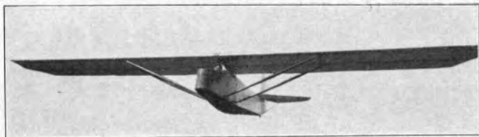
Wagener H. F. V. 17 „Pirat“ (1929) E: H. Wagener, Hamburg; A: H. Wagener, Hamburg. S: 1; St: Schw.; Bst: H; P: Göttingen 535; Gwkl = 1:16; vs = 0,70 m/s. — l = 5,63 m; h = 1,40 m; b = 2,36 m; t = 1,50 m; b/t = 1:8,2; F = 18,20 m 2 ; Gr = 100,00 kg; Gz = 70,00 kg; G = 170,00 kg; G/F = 9,20 kg/m 2 .
