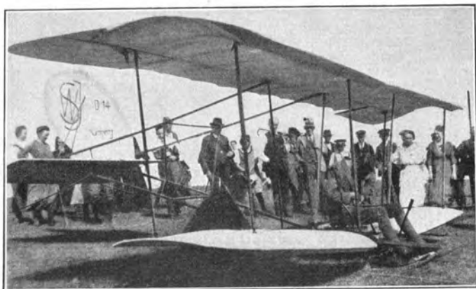
Nürnberg D 14 (1921) E: Ittner, Nürnberg; A: Nordbayr. Luftfahrtverband, Nürnberg. S: 1; St: Schw.; Bst: H. — l = 3,90 m; b = 7,80 m; F = 16,50 m 2 ; T_g = 20,00 kg; L_g = 3,00 kg; R_g = 12,00 kg; Gr = 40,00 kg; Gz = 70,00 kg; G = 110,00 kg; G/F = 6,20 kg/m 2 .
