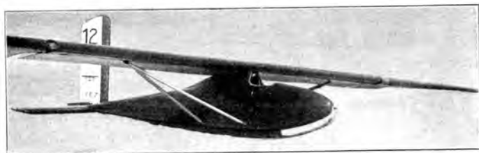
Marcho-Silesia „Seppl“ (1927) E: Marcho-Silesia T. H. Breslau; A: Marcho-Silesia T. H. Breslau. S: 1; St: Schw.; Bst: H. — l = 6,00 m; h = 1,50 m; b = 16,00 m; F = 17,00 m 2 ; Gr = 160,70 kg; Gz = 70,00 kg; G = 230,70 kg; G/F = 13,60 kg/m 2 .
