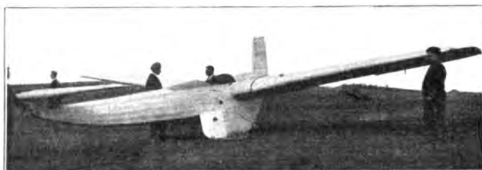
Aachen „Ente“ (1922) E: W. Klemperer, Aachen; A: Aachen. Segelflb. G.m.b.H., Aachen. S: 2; St: K.; Bst: H. l 6,00 m; b 12,00 m; t 1,80 m; b/t 1:6,6; F 22,00 m 2 ; Hfl 3,90 m 2 ; Hr 0,17 m 2 ; Qr 2,40 m 2 ; Tg 38,00 kg; Lg 6,50 kg; Rg 50,00 kg; Gr 94,00 kg; Gz 66,00 kg; G 160,00 kg; G/F 7,30 kg/m 2 .
