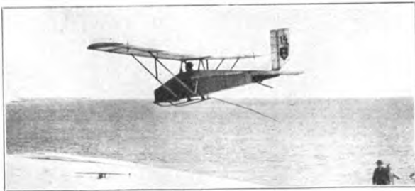
Danzig „Libelle“ (1924) E: H. Wiederhold, Danzig; A: Akademische Fliegergruppe T. H. Danzig. S: 1; St: Schw.; Bst: H. — l = 3,60 m; b = 9,60 m; F = 10,50 m 2 .
