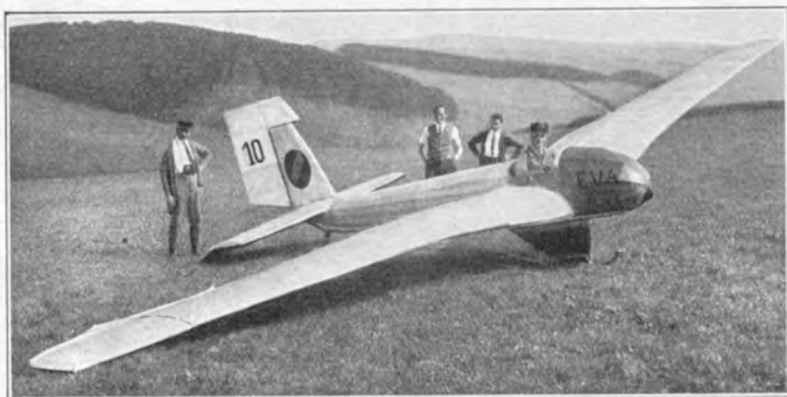
Fulda-Aachen „Eva“ (1925) E: W. Klemperer, Aachen; A: Flugwissenschaftliche Vereinigung T. H. Aachen und Modell- und Segelflugverein, Fulda. S: 1; St: Schw.; Bst: H. — l = 5,70 m; b = 11,50 m; F = 18,00 m 2 .
