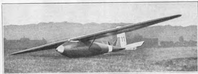
Fulda „Erlkönig“ (1925) E: Modell- und Segelflugverein Fulda; A: Modell- und Segelflugverein Fulda. S: 1; St: Schw.; Bst: H. — l = 5,50 m; h = 1,45 m; b = 14,00 m; t = 1,10 m; b/t = 1:13,0 ; F = 15,00 m 2 ; Gr = 159,00 kg; Gz = 70,00 kg; G = 229,00 kg; G/F = 15,50 kg/m 2 .
