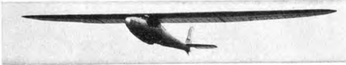
Laubenthal „Württemberg“ (1929) E: Laubenthal, Darmstadt; A: Württembergischer Luftfahrt-Verband, Stuttgart. S: 1; St: Schw.; Bst: H; P: Göttingen 535; vg = 14,85 \text{ m/s} ; Gwkl = 1:20,1 ; vs = 0,68 \text{ m/s} . — B.-L.: D: 2:20:0 h; St: 41 km. — l = 5,70 \text{ m} ; h = 1,30 \text{ m} ; b = 15,20 \text{ m} ; t = 1,03 ; b/t = 1:16,0 ; F = 15,80 \text{ m}^2 ; Hr = 2,14 \text{ m}^2 ; Sr = 0,90 \text{ m}^2 ; Qr = 1,08 \text{ m}^2 ; Tg = 92,70 \text{ kg} ; Lg = 11,50 \text{ kg} ; Rg = 45,00 \text{ kg} ; Gr = 149,20 \text{ kg} ; Gz = 70,00 \text{ kg} ; G = 219,20 \text{ kg} ; G/F = 13,40 \text{ kg/m}^2 .
