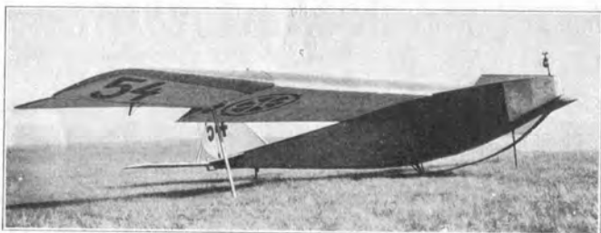
Erfurt „Erfurt“ (1923) E: E. Rommel, Erfurt; A: Erfurter Verein für Luftfahrt e. V., Erfurt. S: 1; St: Schw.; Bst: H; P: Göttingen 430. - l = 6,10 m; h = 1,60 m; b = 12,00 m; F = 22,00 m 2 .
