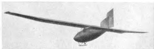
Ksoll „Galgenvogel I“ (1923) E: J. Ksoll, Schön-Ellguth; A: J. Ksoll, Schön-Ellguth. S: 1; St: Schw.; Bst: H. — l = 5,50 m; h = 1,50 m; b = 14,00 m; t = 1,20 m; b/t = 1:11,6 ; F = 17,00 m 2 ; Hr = 2,00 m 2 ; Sfl = 0,60 m 2 ; Sr = 0,70 m 2 ; Gr = 125,00 kg; Gz = 70,00 kg; G = 195,00 kg; G/F = 11,00 kg/m 2 .
