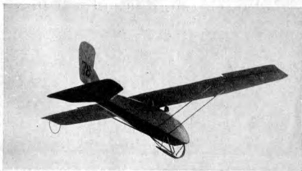
Zwickau „Sorgenkind“. A: Flugtechnischer Verein, Zwickau. S: 1; St: Schw.; Bst: H. — l = 5,40 m; b = 9,30 m; F = 12,30 m 2 .
