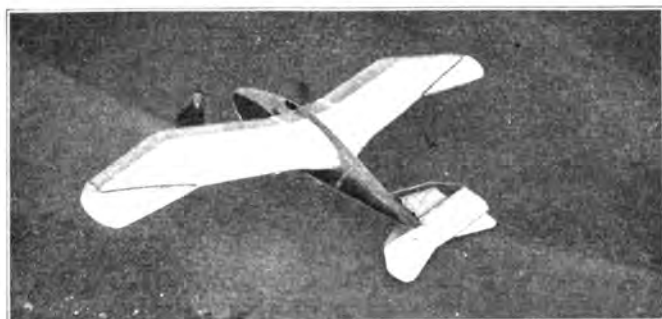
Aachen „Rheinland“ (1923) E: W. Klemperer, Friedrichshafen a./B.; A: Aachener Segelflugzeugbau G.m.b.H., Aachen. S: 1; St: Schw.; Bst: H. l 5,60 m; h 1,25 m; b 12,70 m; t 1,25 m; b/t 1:11,0; F 15,00 m 2 ; Hr 3,00 m 2 ; Sfl 0,60 m 2 ; Sr 0,80 m 2 ; G 102,00 kg; Gz 70,00 kg; Gr 172,00 kg; G/F = 12,00 kg/m 2 .
