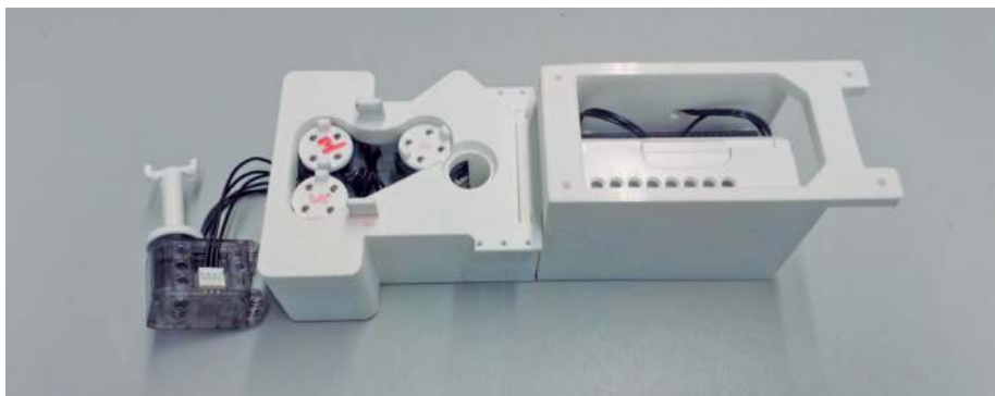
↑ Figura 5. Disseny alternatiu amb els nous servomotors alineats verticalment. Fotografia: autor.
