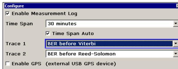
Abb. 17: Betriebsart „TV/Radio Analyzer/Receiver“, Menü MEAS→Measure Log→Configure: Konfiguration für die Bitfehlerratenmessung
