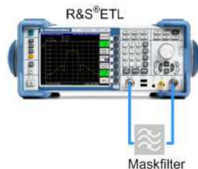
Abb. 8-5: Verkabelung zum Vermessen des Frequenzgangs eines Maskfilters
