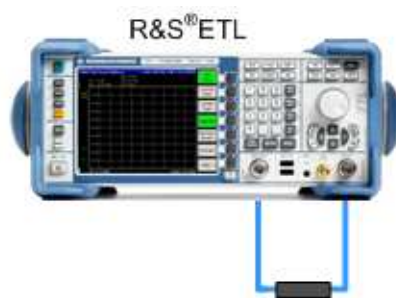
Abb. 8-4: Verkabelung um Kabel zu normalisieren
