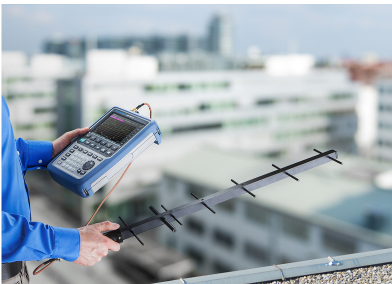
El R&S®Spectrum Rider FPH con una antena Yagi R&S®HA-Z900
