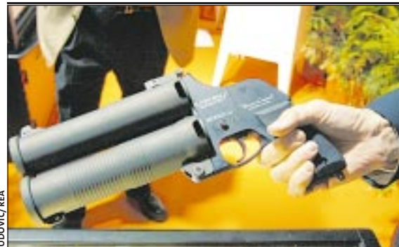
Ce pistolet tire des projectiles d'un diamètre de 4,4 cm jusqu'à une distance de 12 m.
