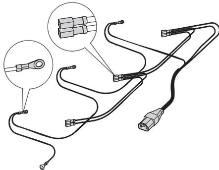
Anschlusskabel und Erdung für 1 ... 3 Ventilatoren
