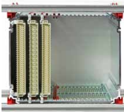
Rückansicht: Kasette in Baugruppenträger eingebaut
