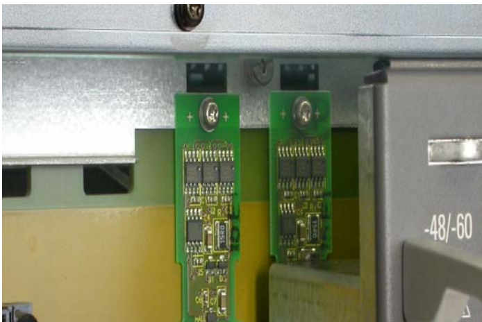
Abbildung zeigt Chassis Data Modul 21596-023
