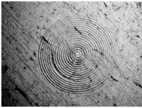
Рис. 7. Доріжки тертя по спіральній траєкторії на покриттях \text{AlN-TiB}_2\text{-TiSi}_2 (а) та ДП (б)
