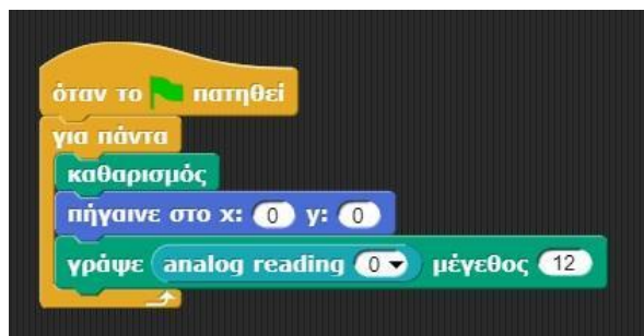
Σχήμα 7: Οι εντολές παρακολούθησης της έντασης φωτός κάθε ένδειξης του φωτεινού σηματοδότη.
