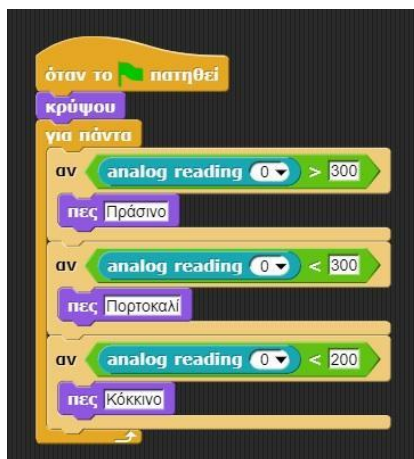
Σχήμα 8: Οι εντολές αναγνώρισης κάθε ένδειξης του φωτεινού σηματοδότη.
