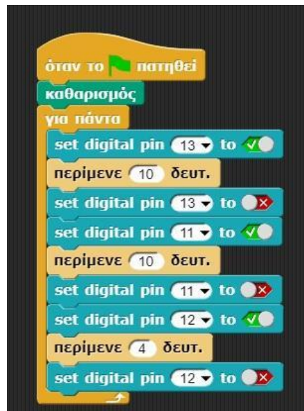
Σχήμα 5 : Κώδικας λειτουργίας φωτεινού σηματοδότη στο Snap 4 Arduino.
