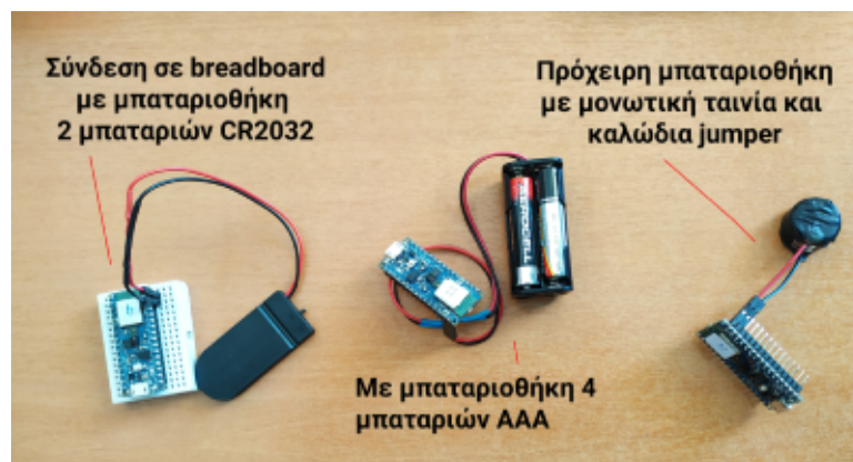
Σχήμα 2: Τρεις τρόποι εξωτερικής τροφοδοσίας των πλακετών.
