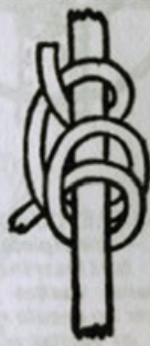
BALLESTRINQUE DOBLE.- Se usa en sustitución del balle- strinque y para contra vientos.
