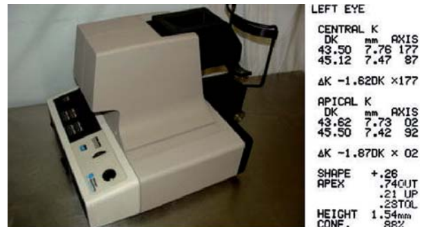
Fig. 9: Autoqueratómetro de Humphrey, aspecto externo (izquierda) y modelo de impresión (derecha).
