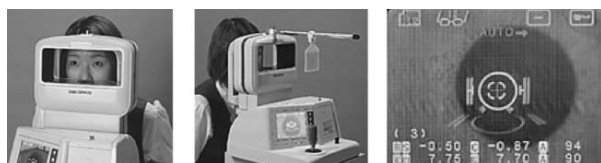
Fig. 27: Autorefractómetro Shin-Nippon NVision-K5001. Izquierda: uso de la ventana de campo amplio. Centro: medida de la visión de cerca con una carta accesoria. Derecha: pantalla con iconos para seleccionar las medidas deseadas.
