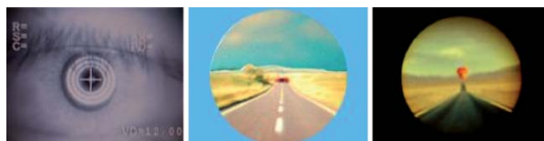
Fig. 19: Imagen del visor para enfoque del refraccionista (izquierda). Sistemas automáticos de fijación (centro y derecha).
