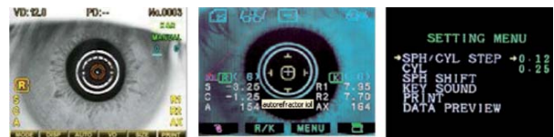
Fig. 20: Diferentes sistemas de pantallas para lectura de medidas. Algunos modelos permiten realizar una refractometría y queratometría simultánea.
