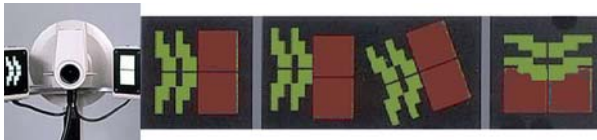
Fig. 5: Izquierda, imagen del queratómetro de Javal-Schiotz: mirando a través del ocular se proyectan sobre la córnea una doble imagen de cada mira. Derecha, imagen de las miras alineadas vistas por el observador, que arrojan una medida del meridiano principal de la córnea. Se han elegido estos colores que son complementarios para que, cuando las miras se superponen, se vea la parte superpuesta de color blanco.
