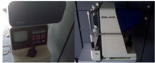
Fig. 15: Imágenes del aspecto externo del autorefractómetro Nikon NR700, basado en la retinoscopia (16).
