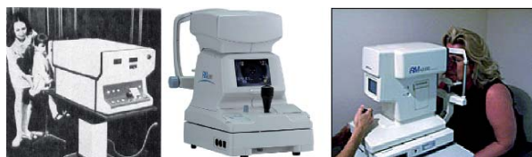
Fig. 18: Imagen del autorefractómetro Acuity Systems 6600 Auto-Refractor, año 1970 (izquierda), y modelo de autorefractómetro Topcon actual, basado en el principio de Scheiner (centro y derecha) (16).
