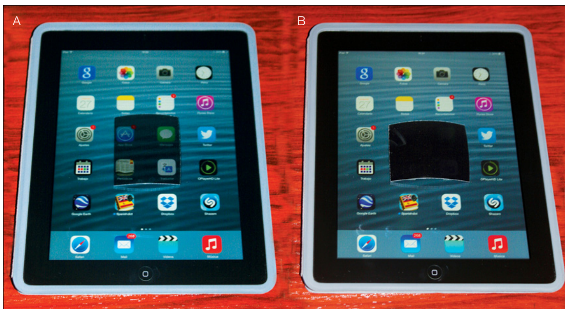
Figura 2-15. Efecto de una lente solar polarizada cuando su eje de polarización es paralelo (A) y perpendicular (B) al eje de polarización de una pantalla de cristal líquido.
