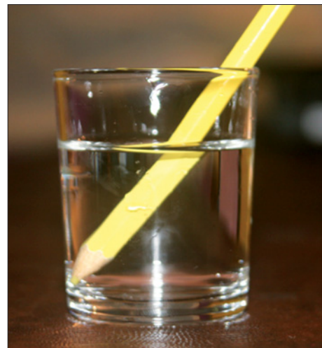
Figura 2-4. Efecto de la refracción producida por el cambio de medio.
