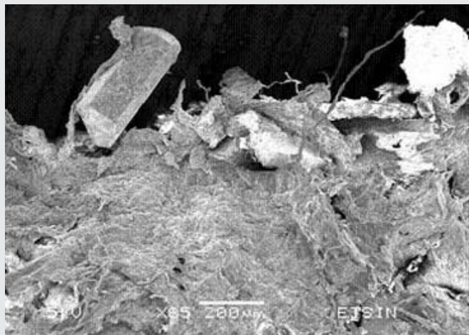
Figura 21. Las adherencias están formadas por algas filamentosas que tienen silicatos (barros) en la que aprecia un pequeño cristal de NaCl
