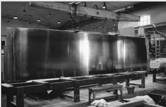
Figura 4: Placa plana, modelo CEHIPAR 2670, para ensayo de pinturas y recubrimientos
