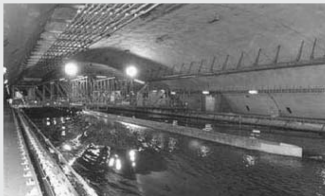
Figura 2: Ensayos de placa plana en el NMRI
