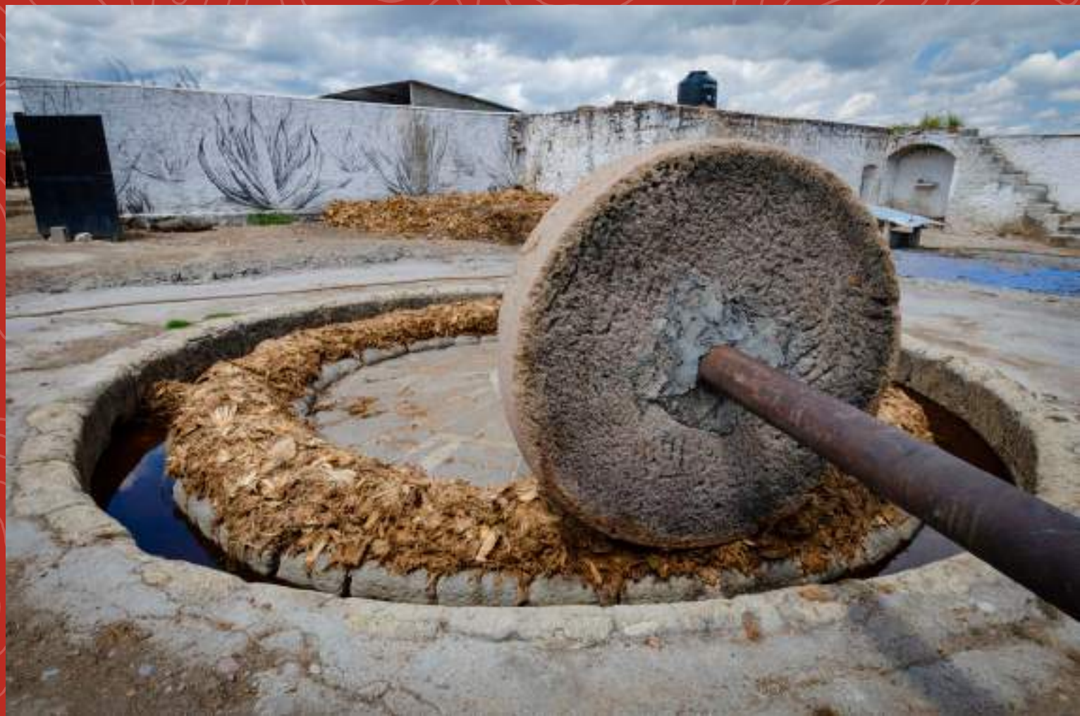
Imagen 2. Molino de piedra o tahona de la hacienda mezcalera de San Francisco, propiedad de la familia Villasuso. Fotografía: Damián Bernal Vega.
